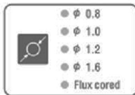
Ábra 5-5: Huzalátmérő kiválasztó zóna
